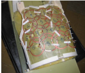
Abbildung 1: Draufsicht auf das Array. Weitere 16 Empfangselemente befinden sich auf der Rückenseite der Form.
