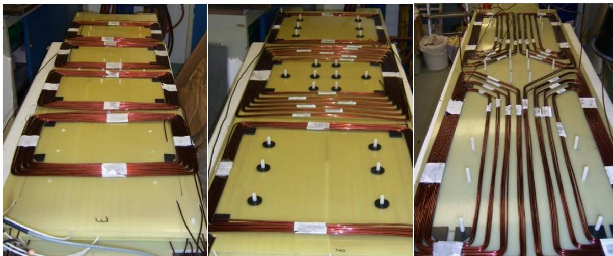
Diese Bilder zeigen die Spulenelemente der einzelnen Kanäle während des Aufbaus.
