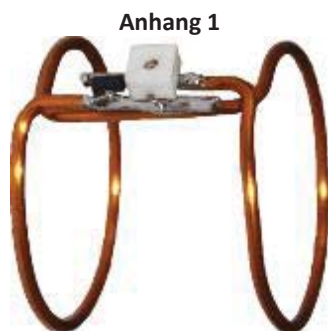
Abb. 1: Induktiv gekoppelte Spule, die zur intraoralen Signalverstärkung auf die Zähne aufgesetzt wird. Diese wird mit einer isolierenden Kunststoffummantelung isoliert und mit einem elastischen Silikonmaterial an die Zahnoberfläche angepasst.
