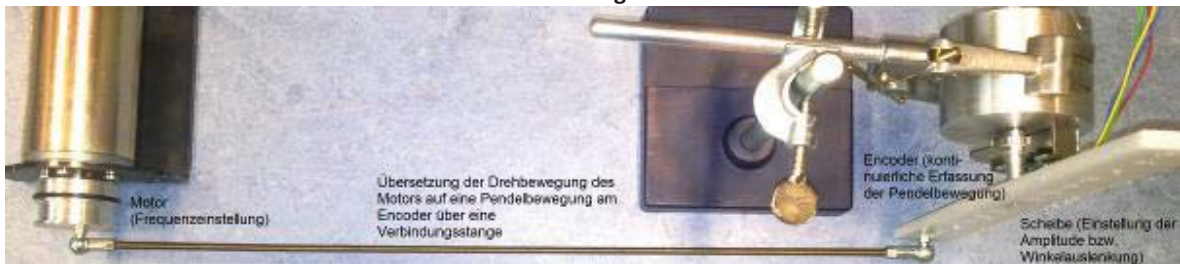
Abb. 1: Messaufbau zur Simulation einer Pendelbewegung am Drehencoder ausgehend von einer kontinuierlichen Drehbewegung am Motor (Frequenzeinstellung) mit optional einstellbarer Winkelauslenkung (Amplitudeneinstellung) an der Scheibe
